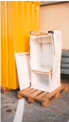
Bild 12: Folge der Verwendung eines nicht explosionsgeschützten Kühlschranks
