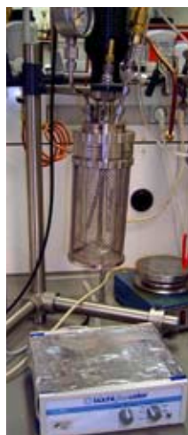
Bild 19b: Glasautoklav mit Drahtkorb t
