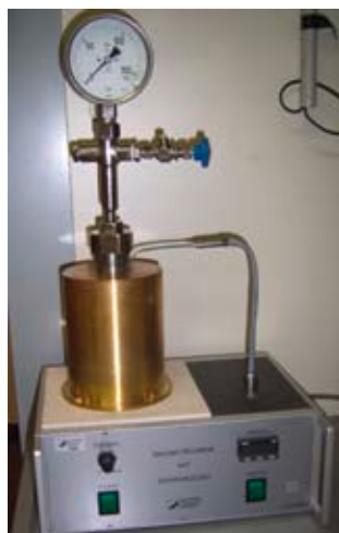
Bild 19a: Handautoklav mit Heizrührer
