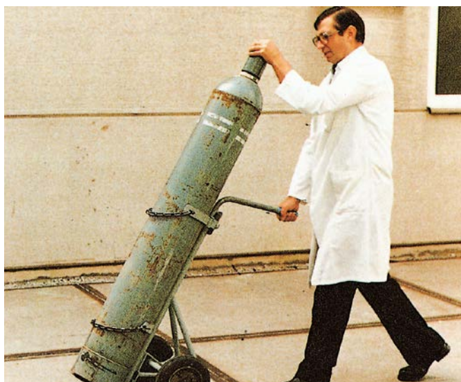
Bild 17: Druckgasflaschen müssen sowohl beim Transport auf den dafür vorgesehenen Wagen als auch am Standort durch Anketten gegen Umfallen gesichert werden.
